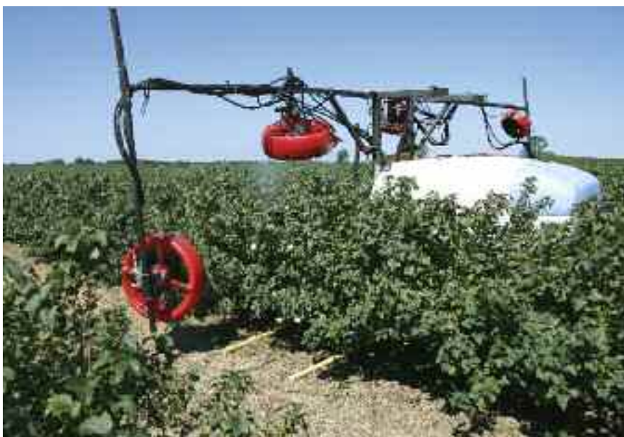
SOLBÆR - Det tager mange forsøg at finde den optimale indstilling af en prototype på en ny sprøjte. Dækning og indtrængning vurderes her med vandfølsomt papir, der er hæftet på bladene samt nogle lister.
