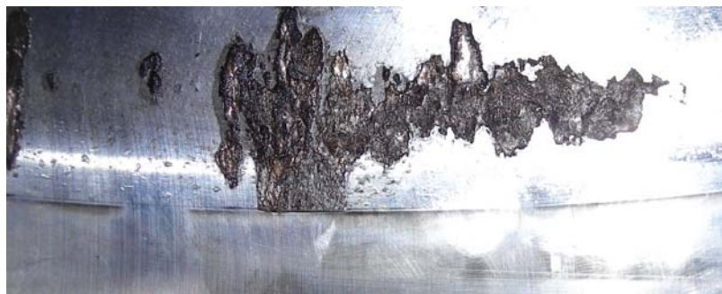
Figure 7:46 Bearing seized, SPM Strängnäs
